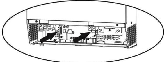
**Шаг 6:** Переподключите 2-контактные и 14-контактные кабели.
