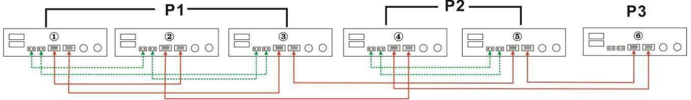
Четыре инвертора в одной фазе, по одному инвертору – в двух других фазах:
