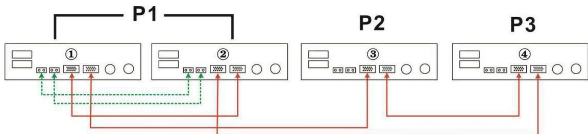
По два инвертора в двух разных фазах, в третьей фазе один инвертор:
