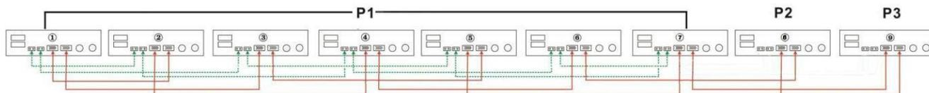
**ПРЕДУПРЕЖДЕНИЕ:** Не подключайте кабель распределения тока между инверторами, которые находятся в разных фазах. В противном случае, это может привести к выходу инверторов из строя.
