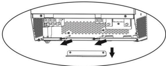
**Шаг 5:** Установите плату параллельного подключения, надежно зафиксируйте её 2 винтами.
