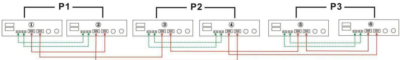
Три инвертора в одной фазе, два инвертора – в другой, один инвертор – в третьей фазе:
