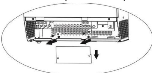
**Шаг 4:** Открутите 2 винта (см. ниже) для отсоединения крышки параллельного подключения
